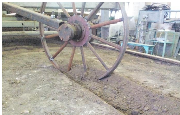
Рис. 1. След от кольца, установленного на тяговой тележке в почвенном канале
