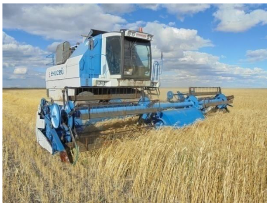
Рис. 1. Хедер с очесывающим адаптером для формирования стерневых кулис с зерноуборочным комбайном «Енисей КЗС-950» в работе
