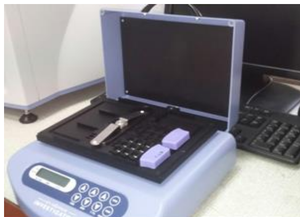
Загрузка биочипа в EvidenceInvestigator (считывающее устройство)
